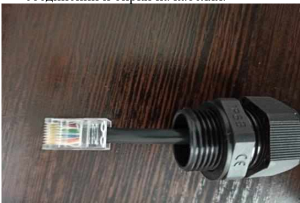
11.5. Фото обжимки всех коннекторов (PoE/Антенна/Клиент) и загерметизированных антенных соединений и бирки на кабелях.
