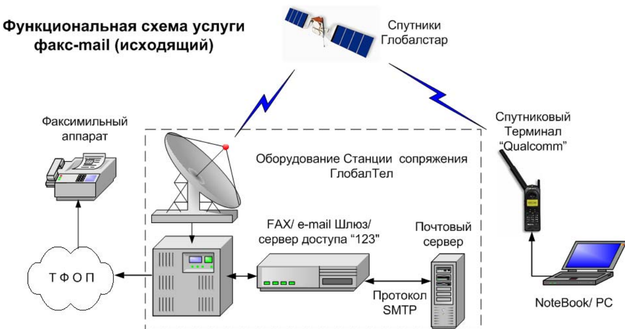
Рис.1 Функциональная схема услуги “факс-мэйл” (исходящий)
